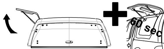
Beim oeffnen der Seitenklappe schaltet sich die Innenleuchte automatisch fuer 60 sekunden ein.
