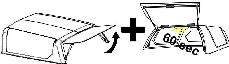
Beim oeffnen der Heckklappe schaltet sich die Innenleuchte automatisch fuer 60 sekunden ein./
